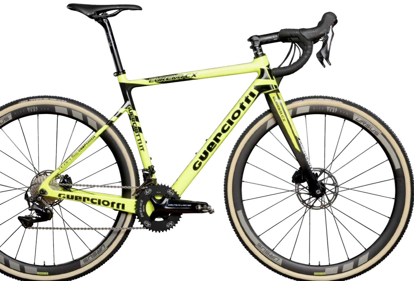
PESO TELAIO / FRAME WEIGHT : Kg 1,050
